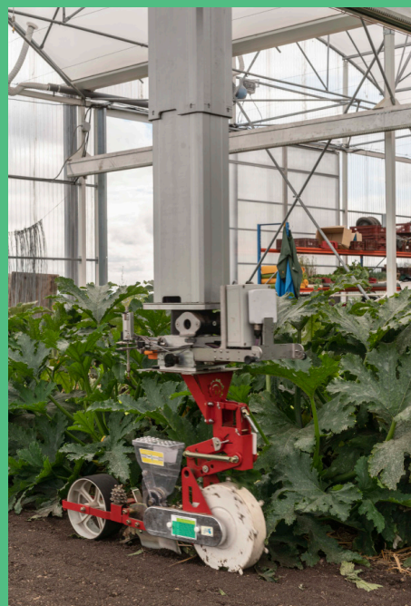
Das Start-up Neofarm baut kleine Betriebe für intensiven Bio-Gemüse-Anbau auf. Der Roboter nimmt den Betreibern viel Arbeit ab – er kann säen, pflanzen, gießen, düngen und ernten
